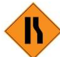
Jalan Raya Menyempit di sebelah kanan
