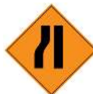
Jalan Raya Menyempit di sebelah kiri
