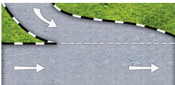
(h) 加速车道的间断单白线
