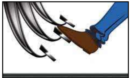
(b) 使用刹车器踏板时，脚跟不可触及车底板。
