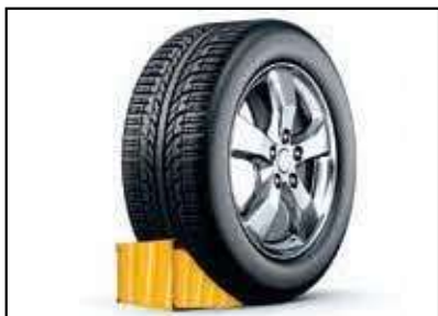
(e) 必要时，将一块楔子塞在车轮底下，以防车子往下溜。
