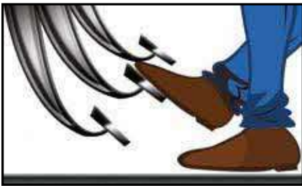
(a) 利用右脚板的前端（脚尖）来踩踏刹车器踏板。
