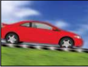
(a) மேட்டின் சரிவு படிப்படியானதாக இருக்கும்போது 3ஆவது கியர் பயன்படுத்தவும்.
