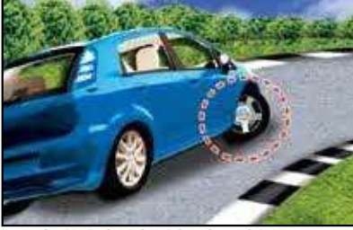
(a) மேட்டில் மேல்நோக்கிய திசையில் இருக்கும்போது முன் சக்கரங்களை வெளியக்கமாகத் திருப்பி வைக்கவும். அப்போதுதான், உங்கள் வாகனம் கீழே சரிந்தாலும், சாலையோர முனையானால் நிறுத்தப்படும்.
