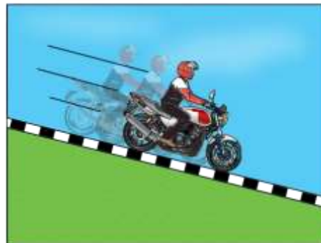
(b) Di cerun yang curam, gunakan gear 2 atau gear 1.
