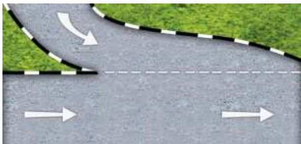
(h) 加速车道的间断单白线
