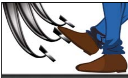
(a) 利用右脚板的前端（脚尖）来踩踏制动器踏板。
