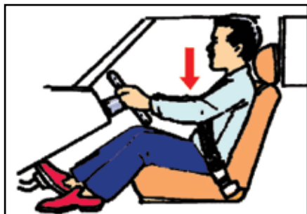
(a) 身体坐直，背部紧靠背垫。手肘稍微弯曲，轻松地握住驾驶盘。
