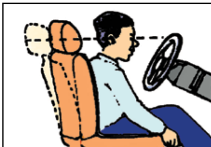
(d) 调整您的头垫使它它与耳朵和眼睛成一直线。这可以防止因后部碰撞而导致颈部受伤的风险。
