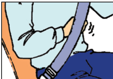
(f) 如果安全带属于非自动式，那么安全带和胸部之间的宽度应以一个拳头大小为限。
