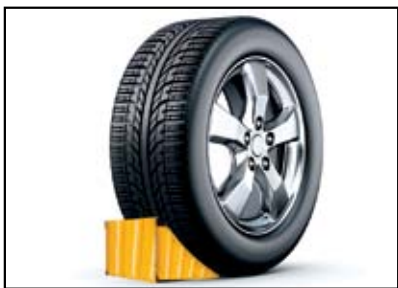
(e) 必要时，将一块楔子塞在车轮底下，以防车子往下溜。
